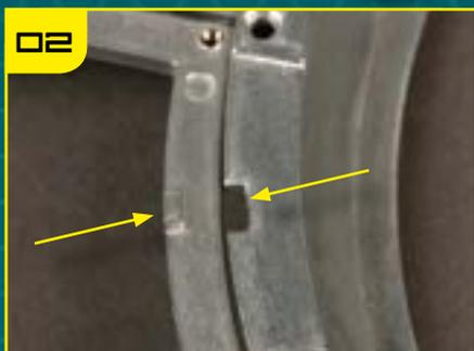
**02** Вырез в кромке кольца турели должен совпасть с выступом на раме каркаса BF-32.
