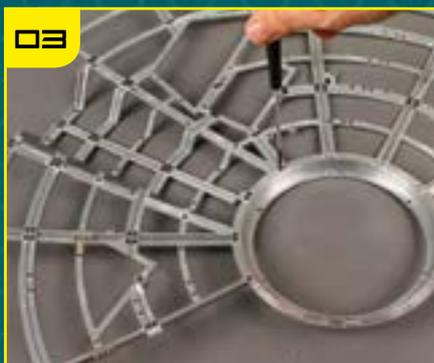
**03** Закрепите кольцо на рамах каркаса с помощью винтов.
